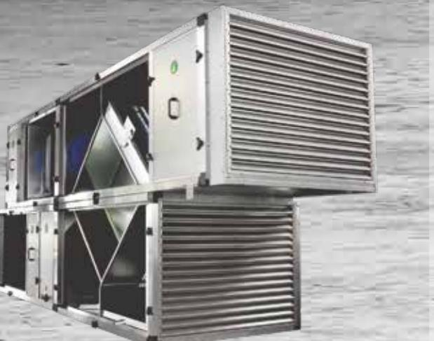
Centrale dachowe w wykonaniu zewnętrznym przeznaczone są do pracy na zewnątrz budynków. Obudowy central wykonane są z płyt warstwowych wypełnionych sztywną pianką poliuretanową lub wełną mineralną, obustronnie pokrytych blachą ocynkowaną. Centrale w wykonaniu dachowym, dodatkowo wyposażone są w daszek, czerpiąc wraz z odkraplaczem, wyrzutnię i kanał skrętny. W celu ochrony przed wpływem warunków atmosferycznych, wszystkie podzespoły automatyki, są umieszczone wewnętrz central.
