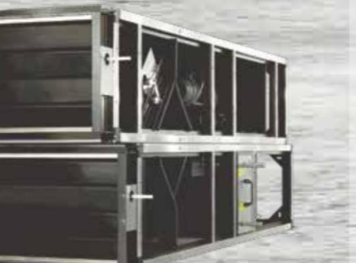
Centrale basenowe ze względu na specyficzne środowisko pracy wykonane są z elementów odpornych na korozję: obudowa i wyposażenie dodatkowe - z blachy epoksydowanej lub nierdzewnej, a wymienniki w wersji epoksydowanej. Automatyka do tego typu central daje możliwość sterowania temperaturą i wilgotnością.
