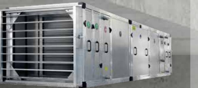
Centrale w wykonaniu wewnętrznym przeznaczone są do pracy wewnętrz budynków, w pomieszczeniach takich jak: maszynowanie, piwnice itp. Obudowy central wykonane są z płyt warstwowych wypełnionych sztywną pianką poliuretanową lub wełną mineralną, obustronnie pokrytych blachą ocynkowaną. Płyty warstwowe stanowią doskonałą izolację termiczną i spełniają rygorystyczne wymagania akustyczne.
